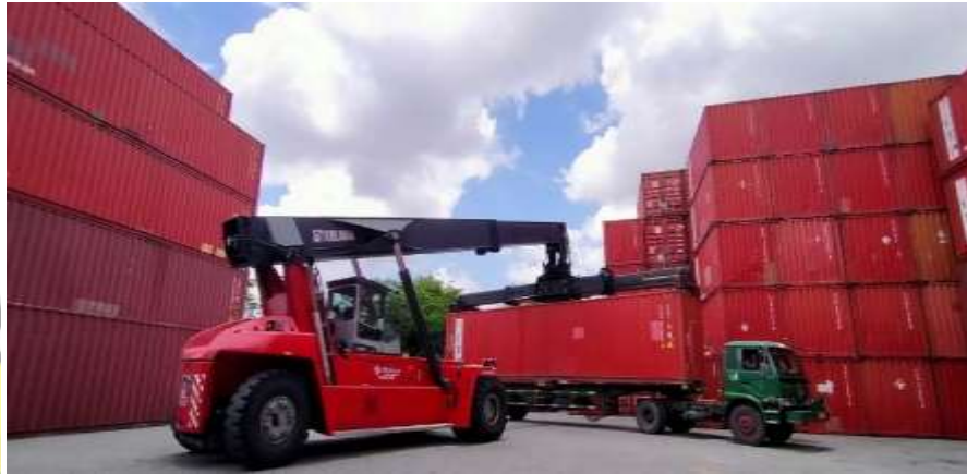
Gambar 2.1 Alat Reach Stacker di Depo Petikemas CDC 3 PT. Pelabuhan Indonesia III (Persero) Cabang Tanjung Perak Surabaya
