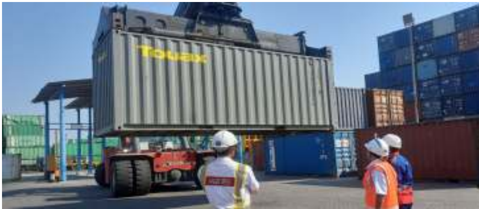
Proses Bongkar/Muat Container Menggunakan Reach Stacker
