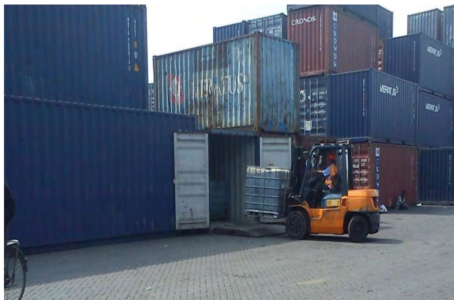
Gambar 2.2 Stuffing in atau dalam , menggunakan alat berat fork lift Sumber: Dokumentasi PT Mitra Dharma Laksana
