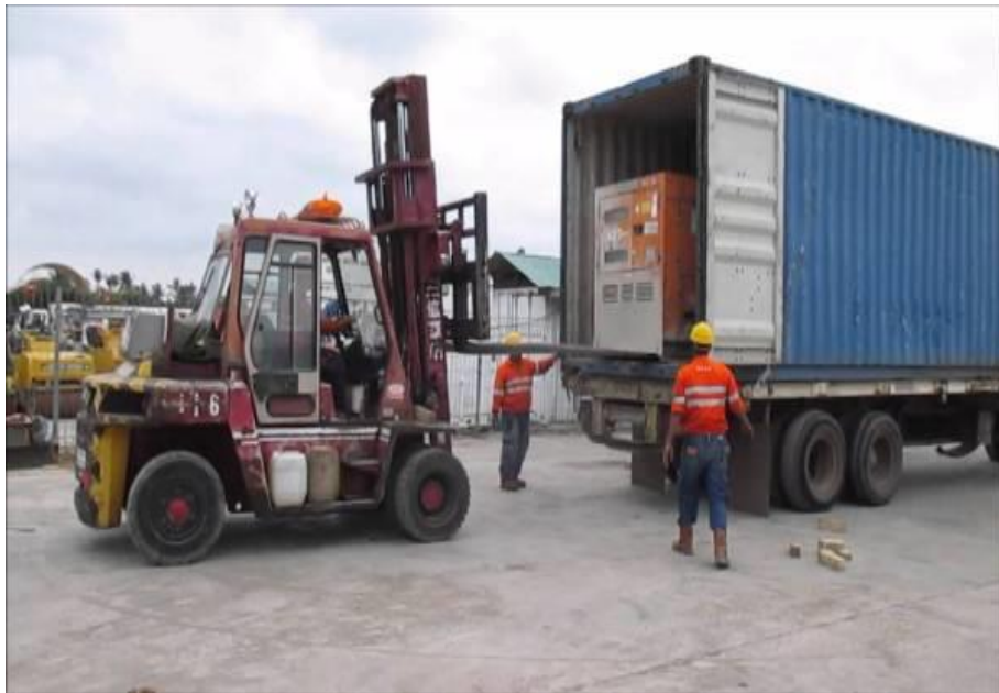
Gambar 2.5 Stuffing out atau luar, dilakukan di pabrik atau luar depo Sumber: Dokumentasi EMKL PT Trans Ocean Services Indonesia
