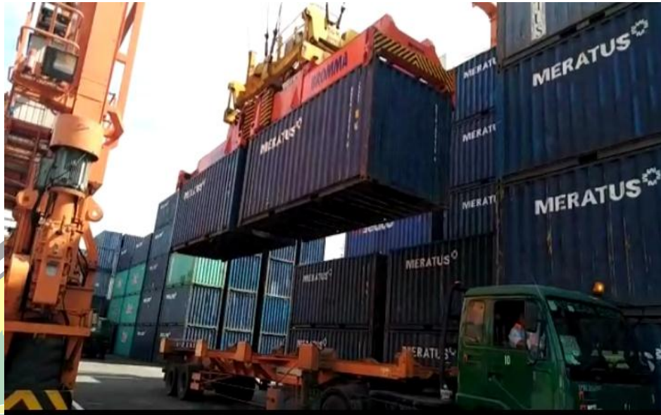
Gambar 2.1 Alat Rubber Tyred Gantry twinlift di lapangan penumpukan Sumber : PT. Nilam Port Terminal Indonesia
